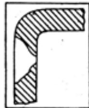
Рис. 2. Отверстие в стенке обоймы насоса
